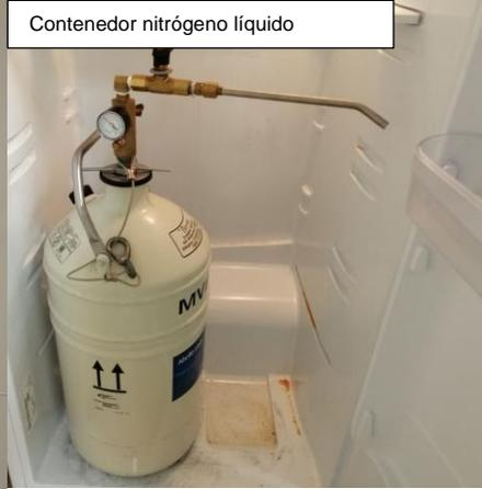
Dispensador nitrógeno líquido
