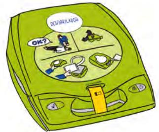
Siga las instrucciones que el mismo aparato nos va indicando. Si hay más de un reanimador durante la colocación de los parches seguir con la RCP. Si la descarga está indicada comprobar que nadie toca a la persona antes de tocar el botón de descarga. Tras la descarga continuar con la RCP.
