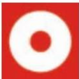
Pulsador de alarma
